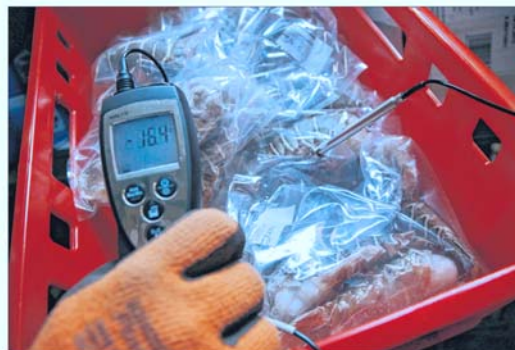
Ein spezielles Thermometer misst die Kerntemperatur der angelieferten Waren.
